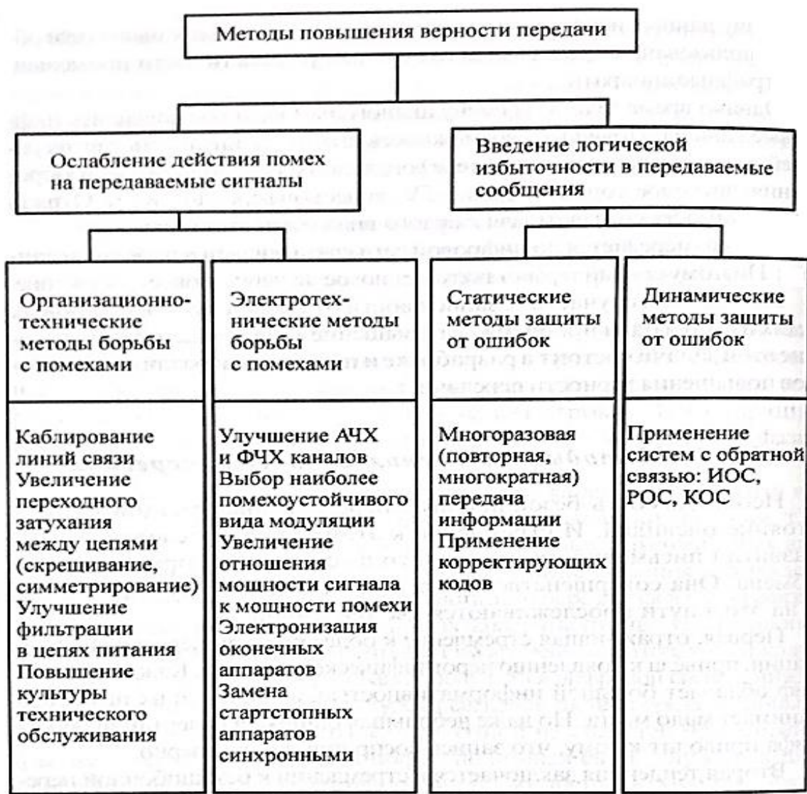
Рис. 7.12. Классификация методов повышения верности передачи
