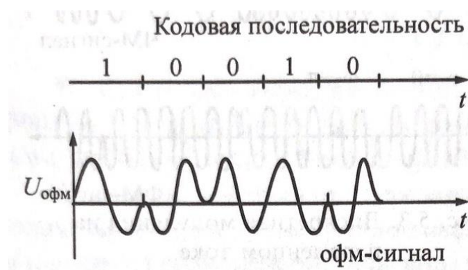
Рис. 7.4. Относительная фазовая модуляция
