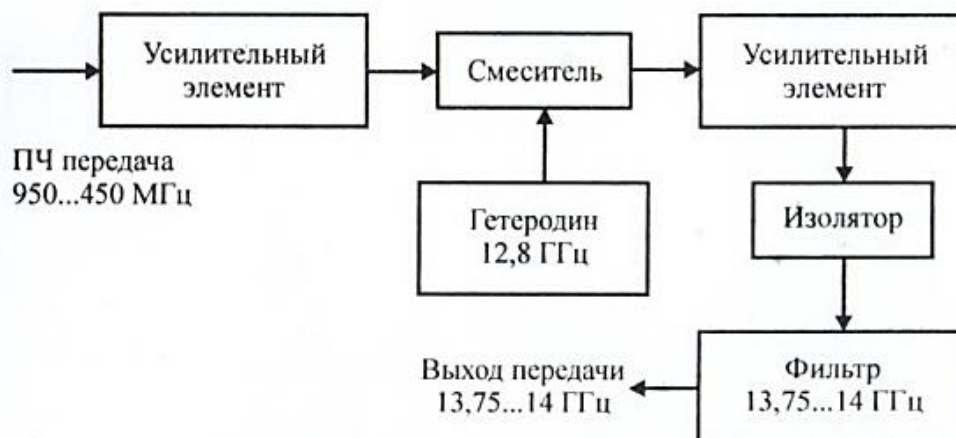
Рис. 8.23. Структурная схема повышающего конвертора
