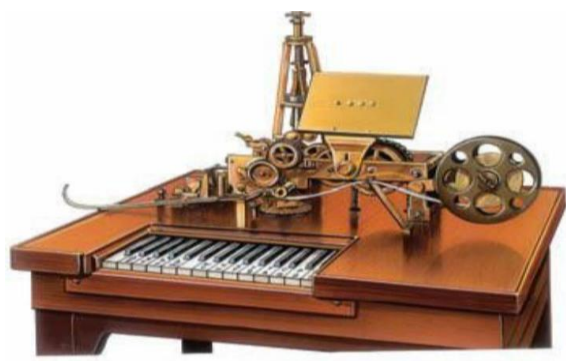
Рис. 2.3. Буквопечатающий телеграфный аппарат
