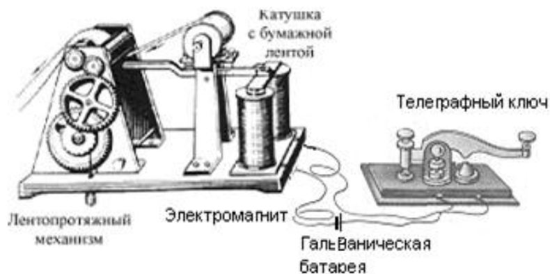
Рис. 2.2. Схема телеграфа С. Морзе
